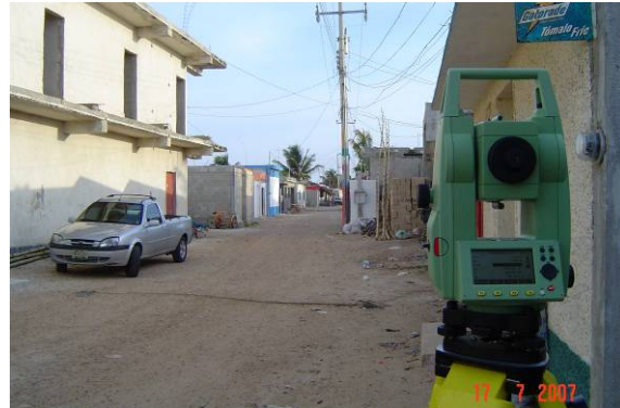
Figura 3.1 Levantamiento topográfico con “estación total”
