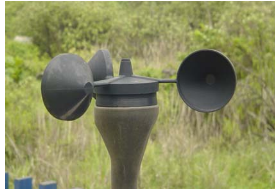
Figura 2.4 Instrumento para medir la velocidad del viento (anemómetro)
